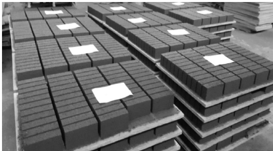
Hình 1. Gạch bê tông được chế tạo từ mẻ trộn thực tế trên dây chuyền sản xuất
