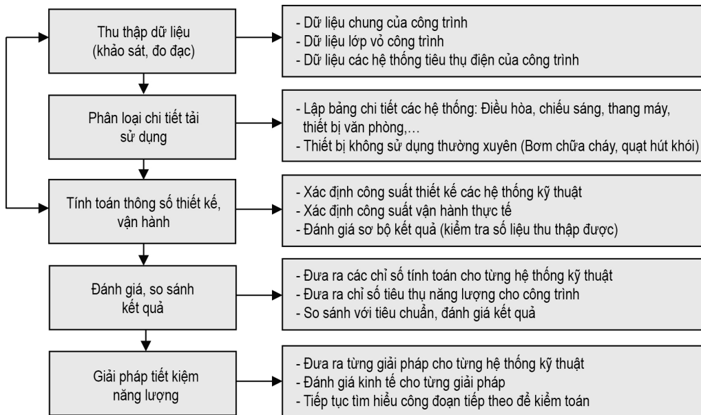
Hình 3. Các bước đánh giá các chỉ số tiêu thụ năng lượng cho tòa nhà
