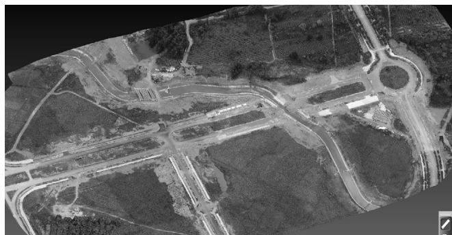
Hình 6. Mô hình 3D được dựng lên từ các điểm ảnh (point cloud)
