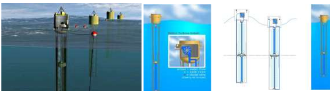
Hình 3. Nguyên lý hoạt động của thiết bị Aqua buoy
