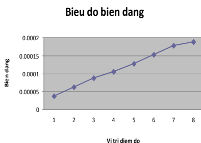
Hình 3. Kết quả đo biến dạng tại 8 điểm
