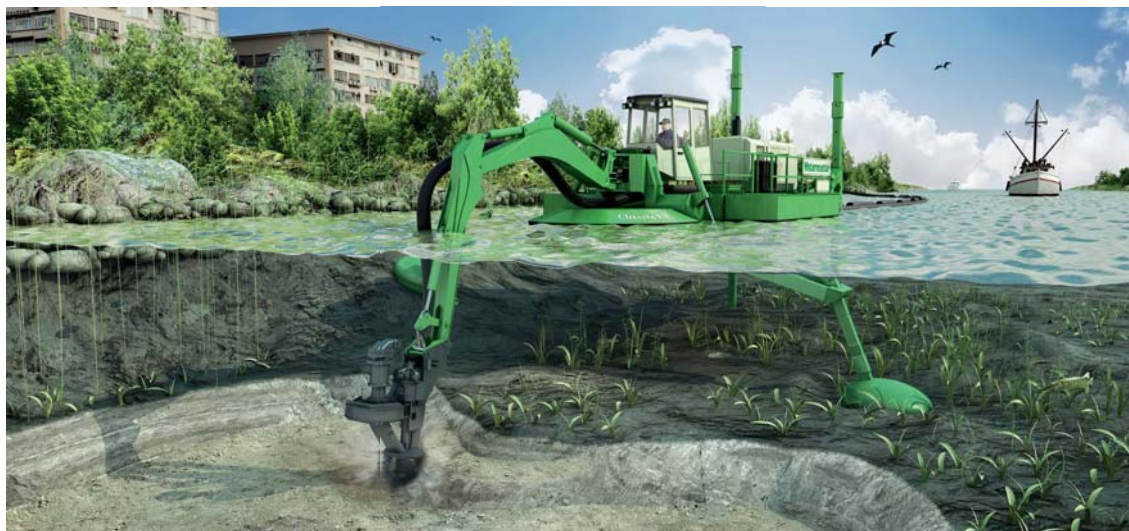
Hình 6. Máy nạo vét có khả năng tự di chuyển
