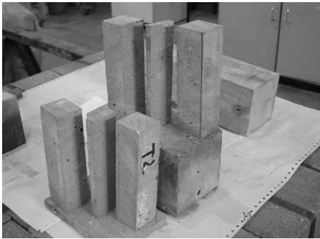
Hình 12. Các mẫu 40×40×160 mm được cắt ra từ mẫu 100×100×350 mm
