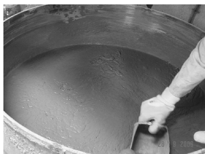
Hình 7. Hỗn hợp bê tông đã đồng nhất
