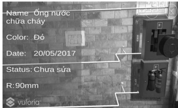
Hình 8. Thông tin chi tiết đường ống nước ẩn sau bức tường
