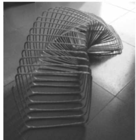
Hình 2. Đai dầm và cột được sản xuất định hình tại nhà máy
