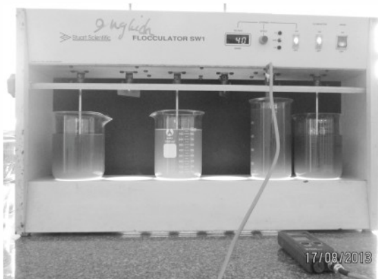
Hình 4. Bộ jar - test để xác định liều lượng hóa chất tối ưu cho nước thải hầm lò mỏ than Mạo Khê
