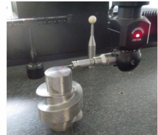
Hình 9. Đo mẫu chế thử trên máy CMM
