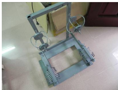
Hình 6. Bộ khung giám chấn dùng cáp phi 6mm
