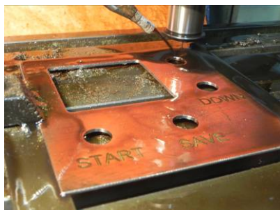
Hình 5. Bề mặt hộp điều khiển cắt bằng máy phay CNC
