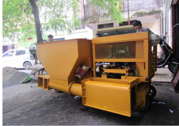
Hình 1. Máy đúc bó vỉa bê tông tự hành BV-60
