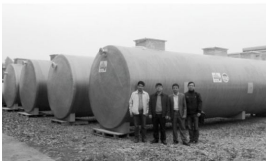
Hình 1. Các bể xử lý nước thải bằng composite tại xưởng chế tạo
