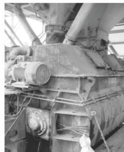
Hình 3. Máy trộn 4500/3000BHS- CS. 180m 3 /h
