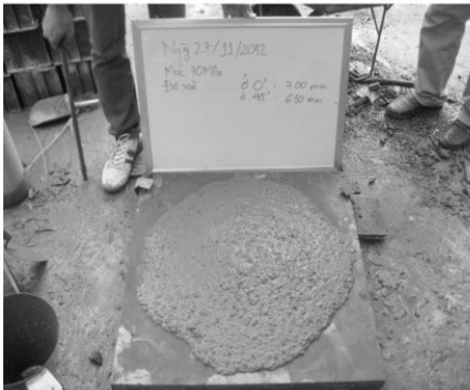
Hình 4. Độ chảy loãng SF của bê tông sau 0h0p và 0h45p sau khi trộn
