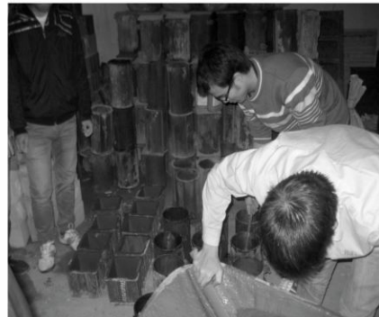
Hình 5. Đúc mẫu bê tông tại nhà máy
