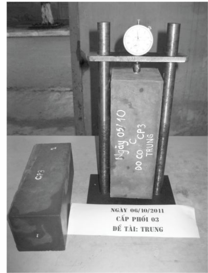
b) Thí nghiệm đo co bê tông
