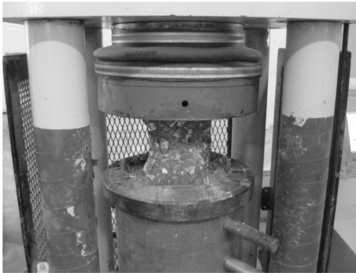
a) Thí nghiệm nén mẫu bê tông
