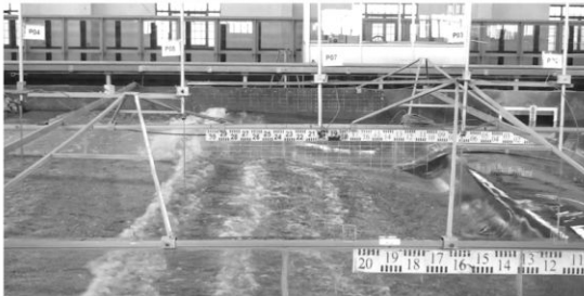
Hình 5. H=10.8\text{m} T=14.27\text{s} -Mặt cắt SW- giai đoạn 1 sóng dâng dạng surging giai đoạn 2 sóng vượt qua thêm san hô và chuẩn bị đổ xuống
