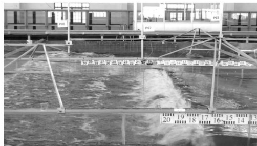
Hình 6. H=10.8\text{m} T=14.27\text{s} -Mặt cắt SW giai đoạn 3 sóng vỡ
