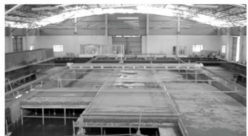
Hình 1. a) Vị trí các điểm lấy số liệu nghiên cứu và mô hình vật lý b) Chế tạo mô hình các mặt cắt đảo trong bể tạo sóng
