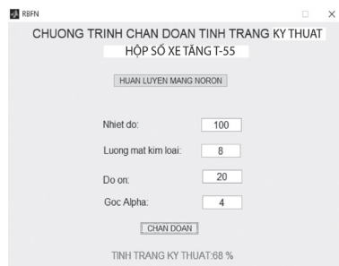
Hình 5. Chương trình chẩn đoán tình trạng kỹ thuật hộp số cơ khí bằng mạng nơ ron RBF
