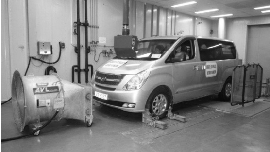
Hình 3. Xác định lực kéo lớn nhất và độ trượt của lốp xe Hyundai Starex CVX trên bộ thử con lăn tại Phòng thử ô tô hạng nhẹ
