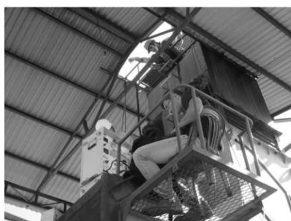
Hình 3. Cán bộ tiến hành đo, lấy mẫu, quan trắc mẫu khí tại hiện trường, vị trí lắp thiết bị làm lạnh nhanh khí thải
