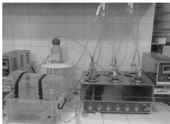
Hình 1. Mô hình thí nghiệm phân hủy kỵ khí theo mẻ ở 55°C
