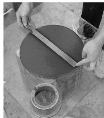
Hình 2. Thí nghiệm đo độ chảy xèo của vữa
