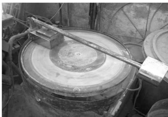
Hình 6. Thí nghiệm độ mài mòn bề mặt của mẫu vữa
