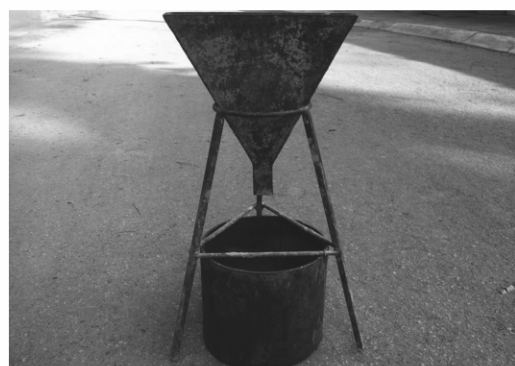
Hình 3. Thí nghiệm thời gian chảy của hỗn hợp vữa qua phễu chữ V
