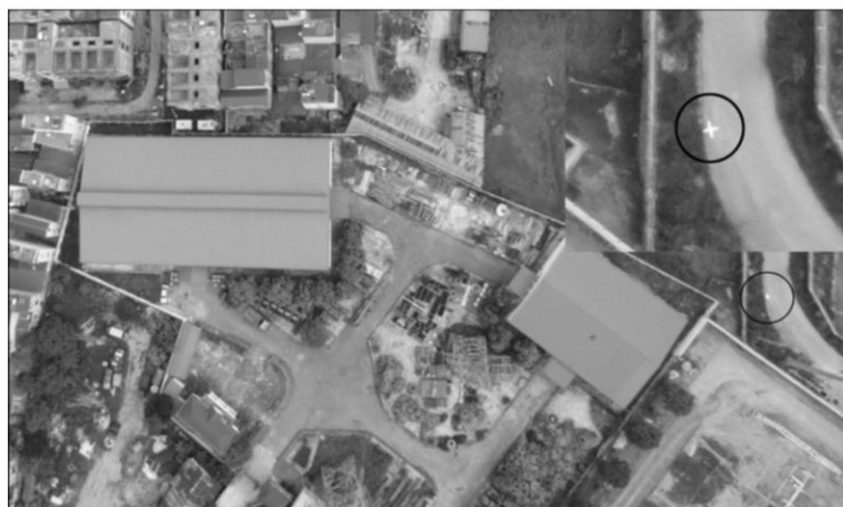
Hình 5. Vị trí đánh dấu điểm khống chế được thu nhận trên ảnh
