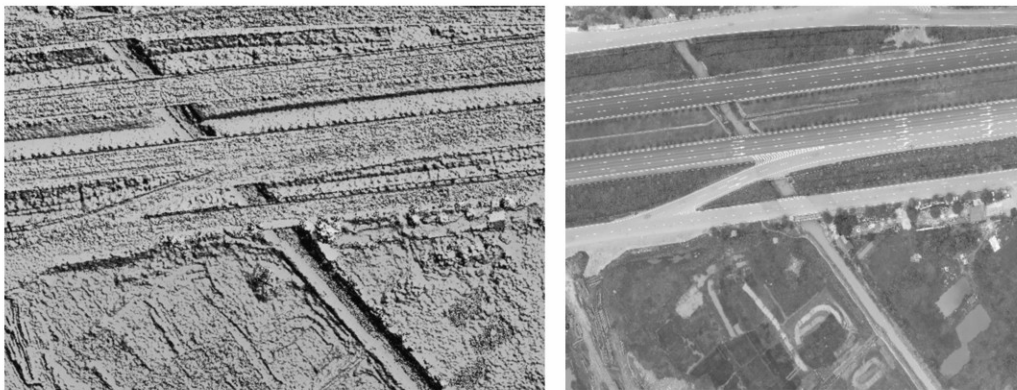
Hình 6. Mô hình số bề mặt (DSM) và bình đồ ảnh trực giao thực (TrueOrtho)
