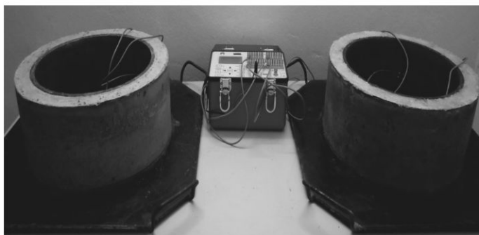
Hình 5. Mẫu thí nghiệm co ngót bị hạn chế của BTCLSC
