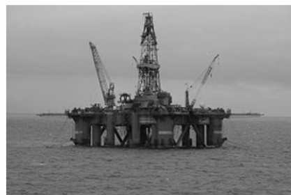
Hình 1. Hình ảnh giàn khoan bán chìm
