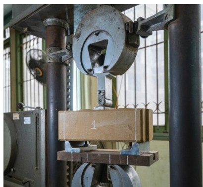
(b) Thí nghiệm uốn thực tế trên máy nén thủy lực YM5A (Liên Xô)
