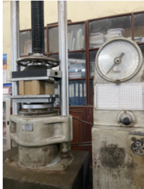
(b) Thí nghiệm nén thực tế trên máy nén thủy lực 50T 2P650 (Liên Xô)
