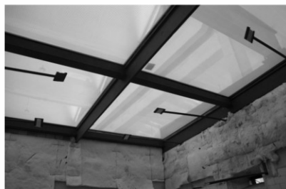
a. Mẫu trước khi thí nghiệm (mặt dưới) b. Mẫu sau khi thí nghiệm (mặt trên) Hình 2. Thí nghiệm chịu lửa hệ kính cửa trời tại Viện Khoa học Công nghệ Xây dựng tháng 5/2014
