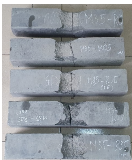
Hình 14. Các mẫu bê tông bị phá hủy sau thí nghiệm chịu tải trọng và đập uốn
