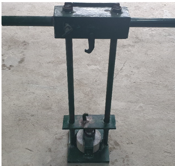
Hình 6. Thiết bị thí nghiệm xác định khả năng chịu tải trọng và đập rơi tự do
