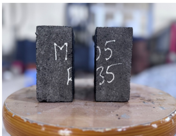
(a) Cắt mẫu bê tông
