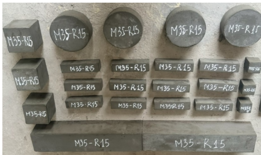
Hình 3. Các mẫu bê tông M35-R15 sau khi tháo khuôn
