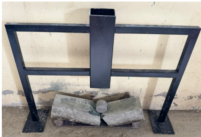
Hình 7. Thiết bị thí nghiệm xác định khả năng chịu tải trọng và đập uốn
