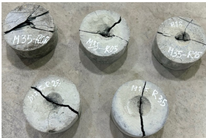
Hình 12. Các mẫu bê tông bị phá hủy sau thí nghiệm chịu tải trọng va đập rơi tự do
