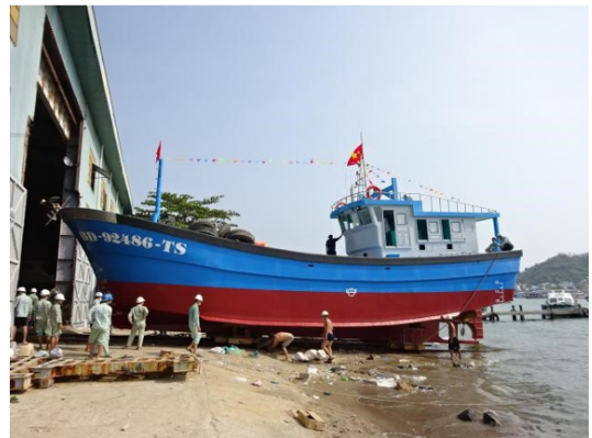
Hình 2. Tàu vỏ composite hạ thủy tại Viện NCCT tàu thủy
