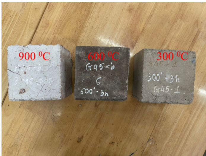
Hình 11. Ảnh các mẫu bê tông sau khi bị nung ở các mức nhiệt độ khác nhau
