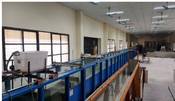
Hình 5. Thí nghiệm vật lý giảm sóng tràn dùng tấm có lỗ rỗng
