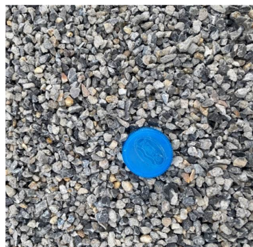
Hình 2. CLTC từ PTXD sau khi gia công
