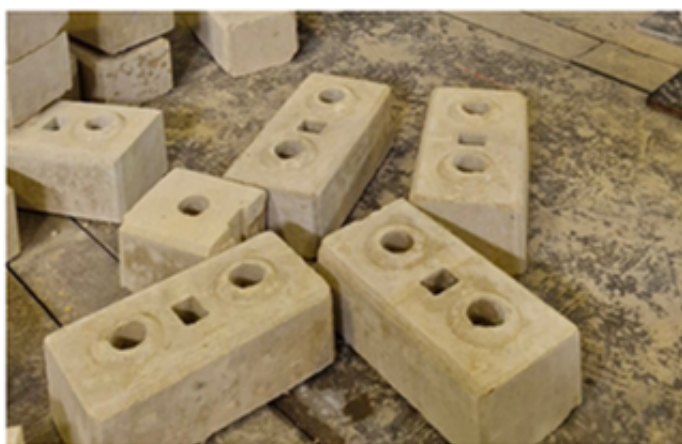
Hình 4. Gạch sử dụng cho mẫu thí nghiệm
