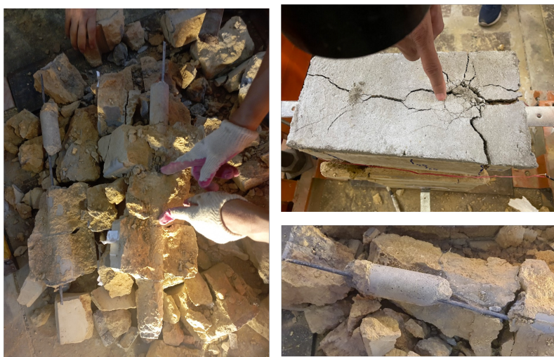
Hình 14. Dạng phá hoại của sườn đứng trong mẫu thí nghiệm
