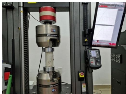
(a) Thí nghiệm nén mẫu vữa
