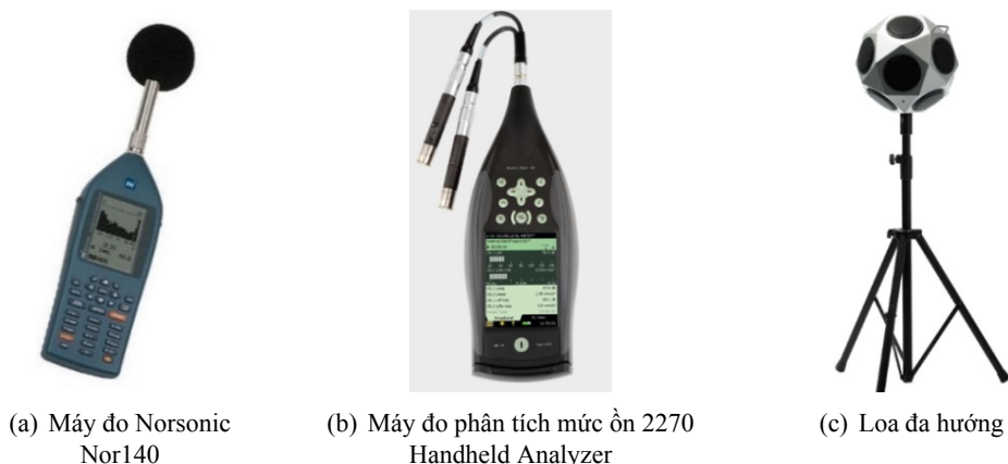
Hình 3. Các thiết bị đo mức ồn nền và thời gian âm vang theo dải tần số
