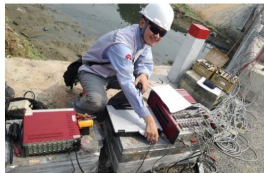
Hình 9. Đầu nối, hiệu chỉnh thiết bị đo
