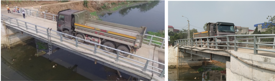
Hình 6. Xe chạy qua cầu thử tải động
