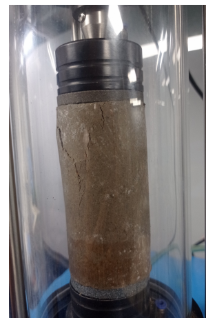
Hình 5. Hình ảnh minh họa mẫu bị phá hoại trong thí nghiệm UCS
