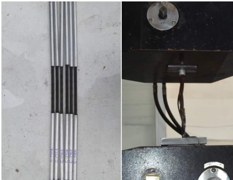
Hình 2. Gia công và thí nghiệm xác định cường độ chịu kéo của cáp
