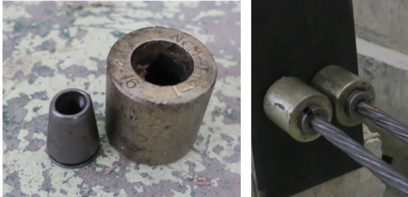
Hình 1. Đầu neo và loại cáp sử dụng cho đầm thí nghiệm
