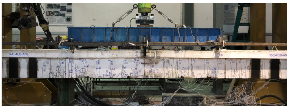
Hình 8. Sơ đồ thí nghiệm và lắp đặt thiết bị đo của các dầm
