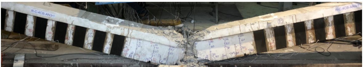
(e) Dầm RC4-AN3r1 bị nén vỡ bê tông vùng nén và liền sau đó là bong tách tấm CFRP trong nhịp uốn
