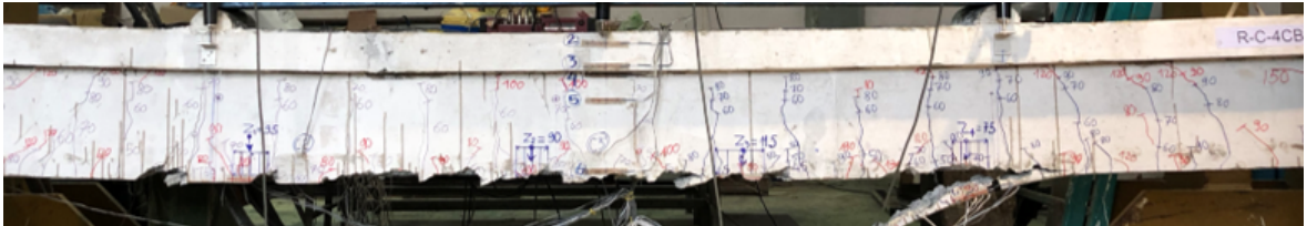
(b) Dầm RC4 bị bong tách tấm CFRP trong nhịp cắt và lớp bê tông bảo vệ trong nhịp uốn
