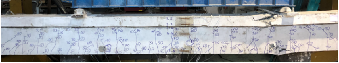
(a) Dầm RC0 bị nén vỡ bê tông vùng nén giữa nhịp uốn
