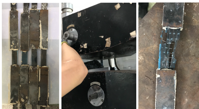
Hình 4. Công tác gia công và kéo thí nghiệm mẫu tấm CFRP
