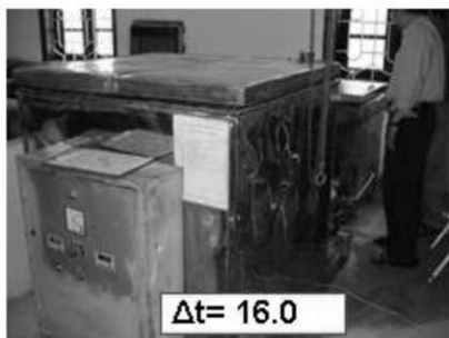
Hình 8. Thí nghiệm đoạn nhiệt RCC: \Delta t = 16^\circ\text{C} ; (PECC 1)
