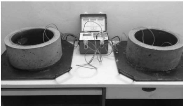
Hình 4. Hình ảnh thí nghiệm Vòng kiểm chế (mẫu BTCST)
