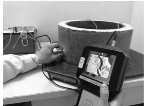
Hình 5. Đo bề rộng vết nứt trên vành bê tông
