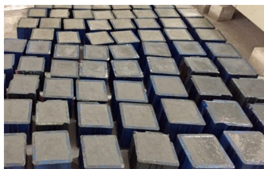
Hình 5. Mẫu xác định cường độ chịu nén của bê tông
