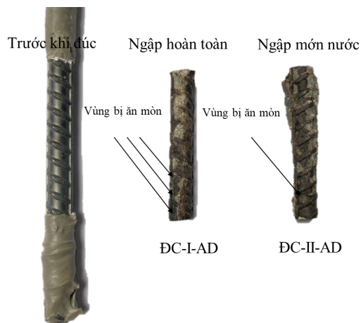
Hình 13. So sánh ảnh cốt thép trong 2 mẫu bê tông ĐC bị nứt theo tiêu chuẩn NT BUILD 356 ở chế độ ngập hoàn toàn và ngập môn nước
