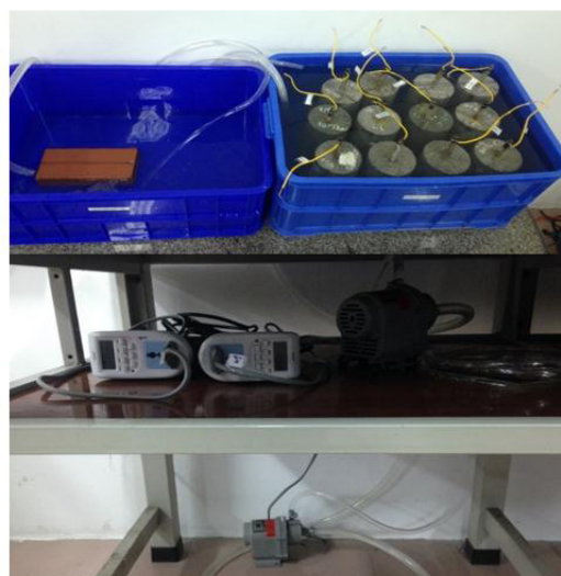
Hình 3. Ảnh chụp hệ bơm hẹn giờ tự động và mẫu bê tông ngập chu kỳ
