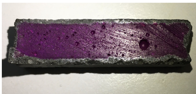
Hình 2. UHPC bị ăn mòn trong dung dịch \text{NH}_4\text{NO}_3 5M
