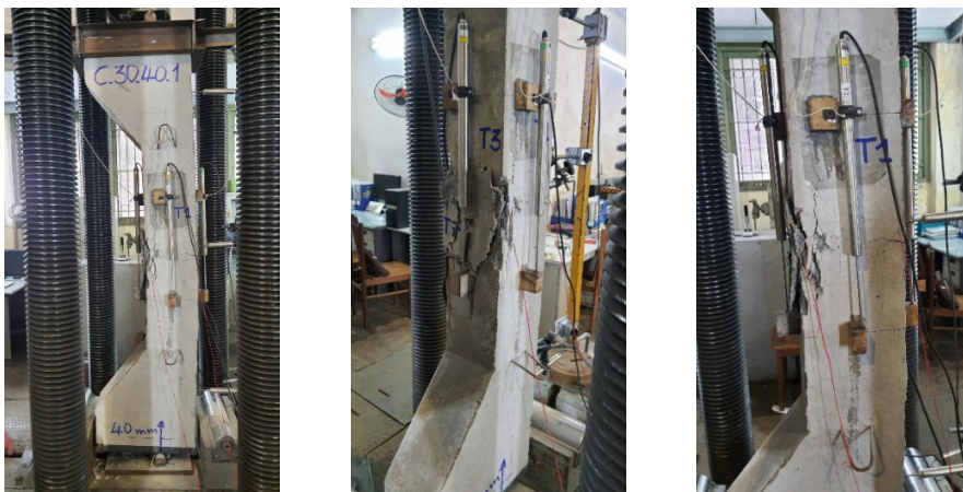
Hình 9. Dạng phá hoại của mẫu cột C-30-40-1
