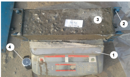
Hình 1. Xác định sự mất nước của bê tông; 1- Cân điện tử; 2- khuôn BT; 3- mẫu BT; 4- đồng hồ đo thời gian
