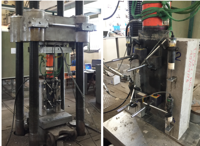
Hình 4. Hình ảnh quá trình thí nghiệm đẩy
