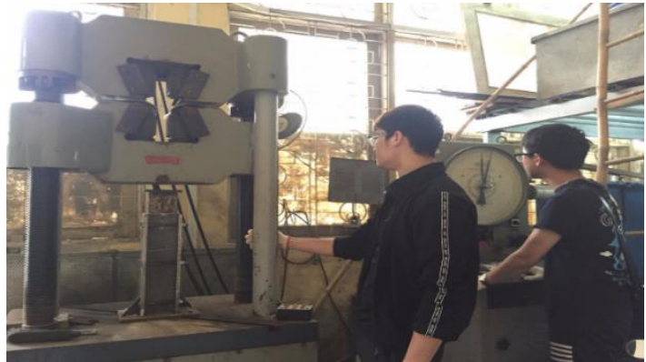
Hình 4. Tiến hành thí nghiệm xác định quan hệ độ lún và lực ép
