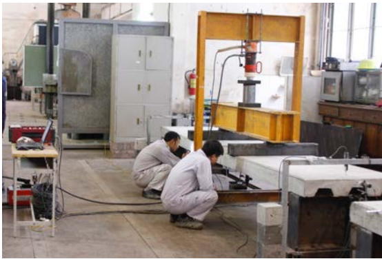
Hình 6. Hình ảnh quá trình thí nghiệm mẫu sàn liên hợp
