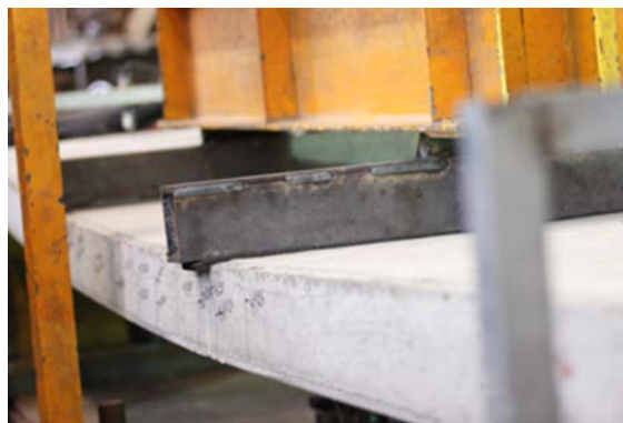
(a) Sàn bị võng lớn gây bong liên kết giữa tấm tôn và bê tông ở vùng giữa nhịp
