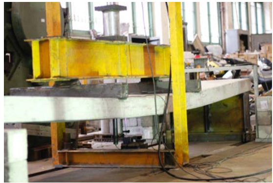
Hình 6. Hình ảnh quá trình thí nghiệm mẫu sàn liên hợp
