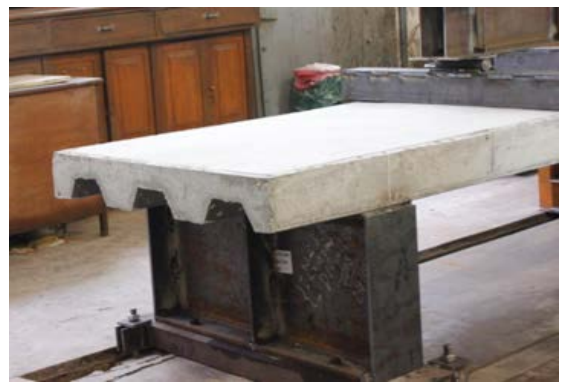
(b) Dầm thép I600 làm gối đỡ
