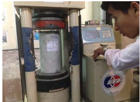
(b) Thí nghiệm nén mẫu bê tông
